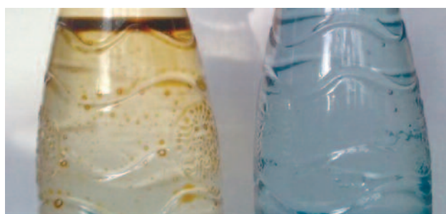
Рисунок 7. Результат очистки нефтесодержащих сточных вод на магистральной установке «Криброл» за один проход через разделительный картридж. а – вода до фильтрования б – вода после фильтрования
