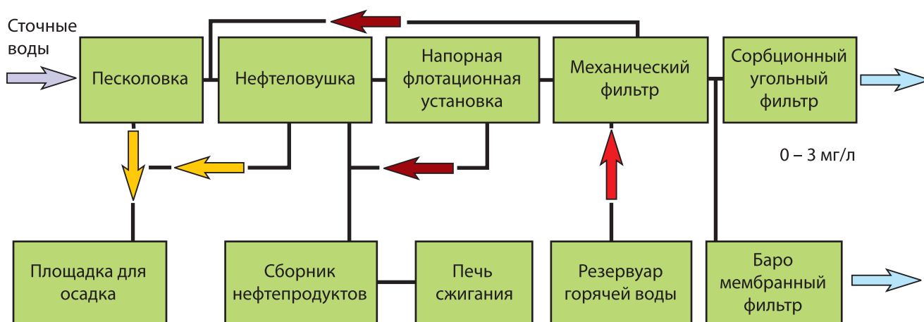
Рисунок 2. Структурная схема очистки сточных вод от нефтепродуктов с глубокой доочисткой после напорной установки на механических сорбционных фильтрах
